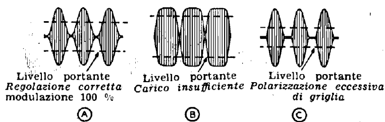
Figura 2. FORMA D'ONDA ALL'USCITA DI UN AMPLIFICATORE LINEARE Forme dell'involucro della por- tante ottenuto con regolazione esatta o errata in un amplifica- tore lineare in classe B.
